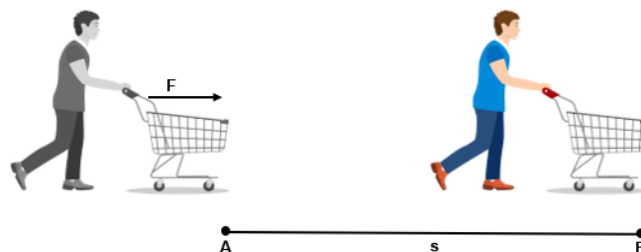
Gambar 2. 4 Perpindahan Searah dengan Gaya Pada Troli
