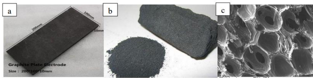
Gambar II. 1 a) Lempeng grafit b) Serbuk grafit c) Hasil analisis SEM [42]
