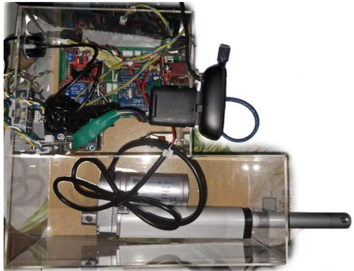
Gambar 5.3 Posisi Aktuator Tidak Rem
