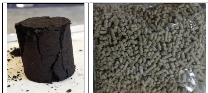
Gambar 1. Sampel biobriket dari serbuk gergaji kayu, tempurung kelapa dan pelet kayu kaliandra
