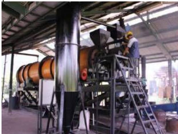
Gambar 2. *Rotary Kiln* untuk karbonisasi
