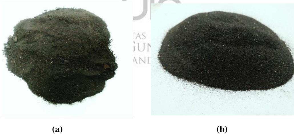
Gambar I.1 (a) Slag sebelum dipreparasi (b) Slag yang telah melalui proses preparasi
