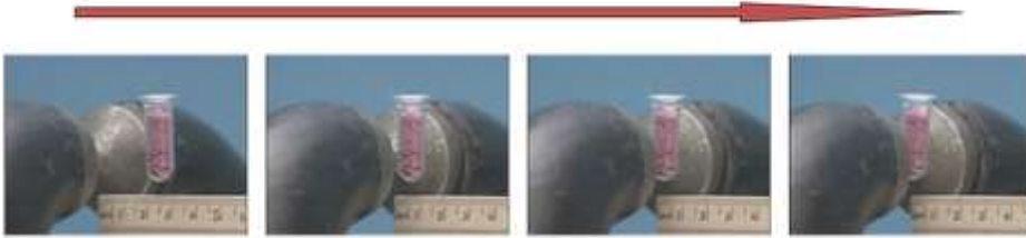
Gambar 6. 9 Metode pengukuran sifat kemagnetan suatu senyawa logam transisi
