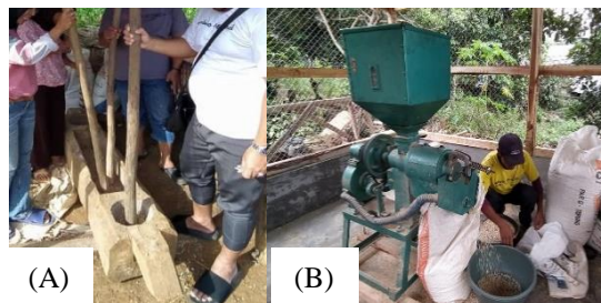
Gambar 5. Alat Pemecah Biji Hanjeli (A) Tradisional dan (B) Modern
