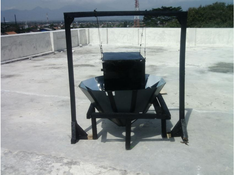
Gambar 4.2 Alat Pengering SD 2 yang berhasil dibuat
