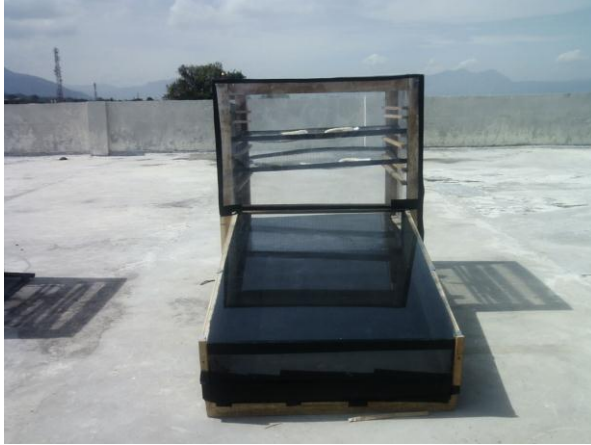
Gambar 4.1 Alat Pengering SD 1 yang digunakan dalam mengeringkan pisang
