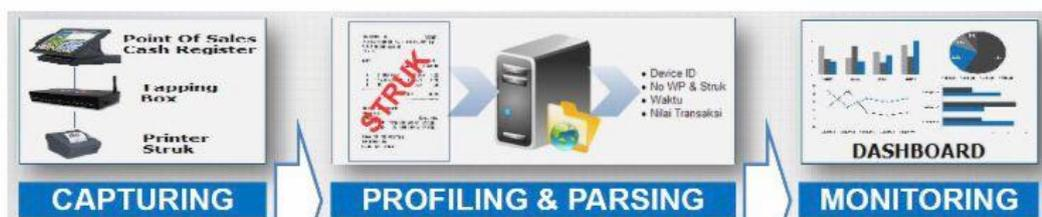
1. Capturing, dimana alat *Tapping Box* mencatat setiap transaksi yang dikeluarkan oleh mesin kasir lalu mengirimkan ke server melalui jaringan GSM dalam bentuk RAW data
