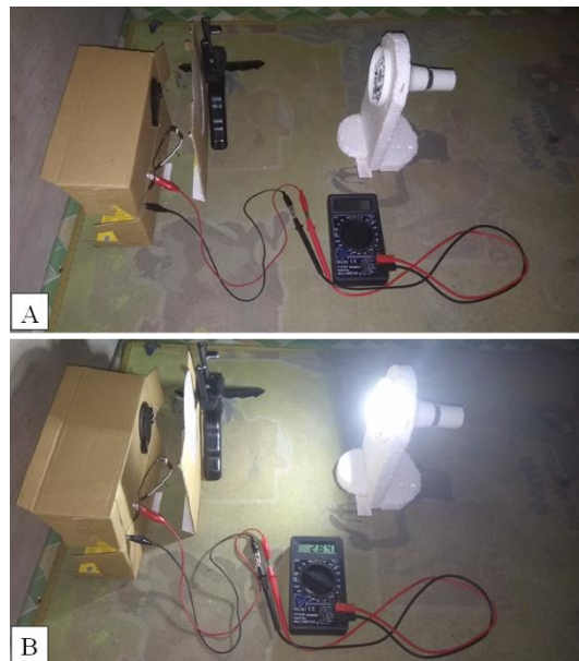
Gambar 4. 4 Model rangkaian photovoltaik dan variasi beban (a) sebelum diberi sumber cahaya (b) setelah diberi sumber cahaya
