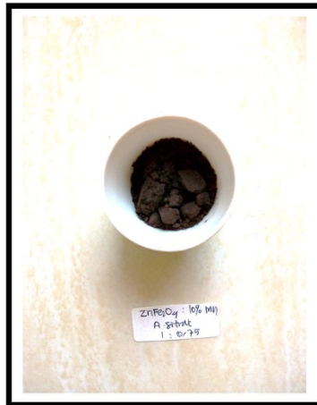
Gambar 4. Serbuk material Sensor yang disintesis menggunakan teknik sol-gel.
