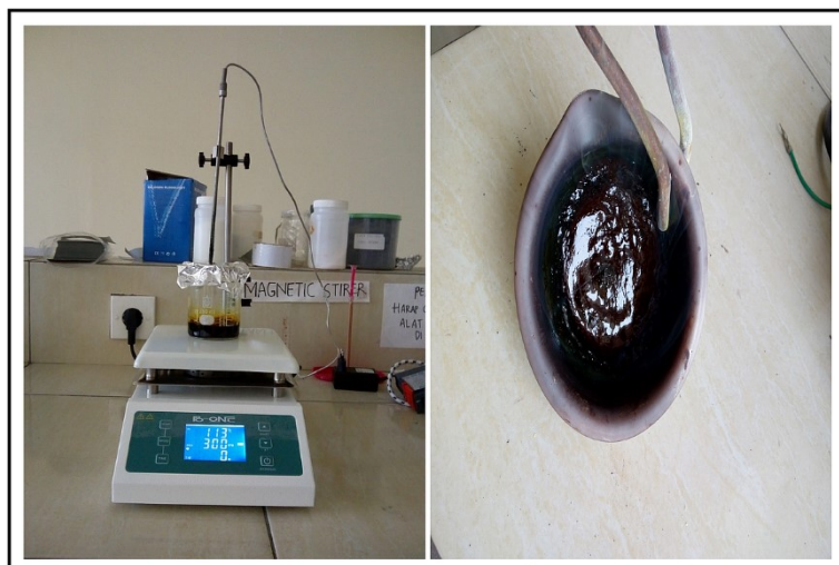
Gambar 10. Proses pelarutan campuran logam (kiri), campuran sudah membentuk gel (kanan).
