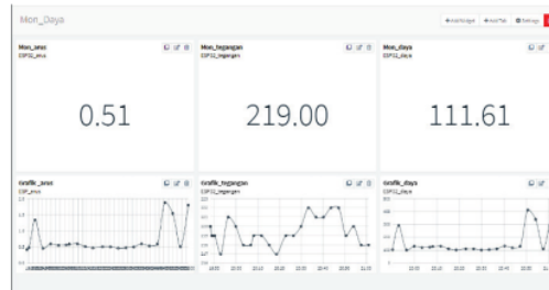
Fig. 4. Display data logger on Thingier.IO
