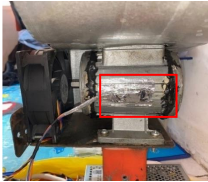
Gambar 4. 7 Penempatan sensor DHT22 pada motor induksi.
