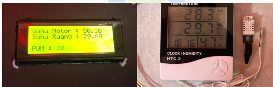
Gambar 5. 2 Perbandingan DHT22 dan termometer digital ruangan.
