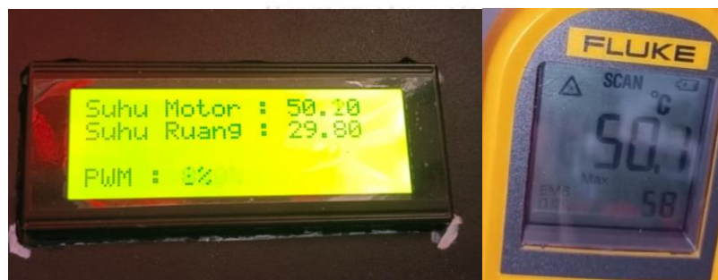
Gambar 5. 4 Pembacaan temperatur motor steady di 50°C.
