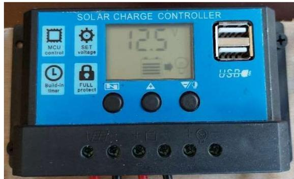
Gambar 5.2 Pengecekan SCC
