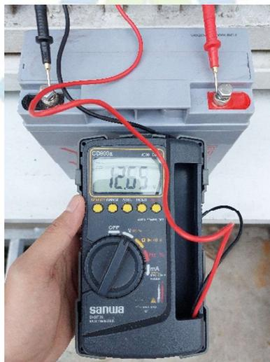
Gambar 5.1 Pengecekan baterai menggunakan multimeter
