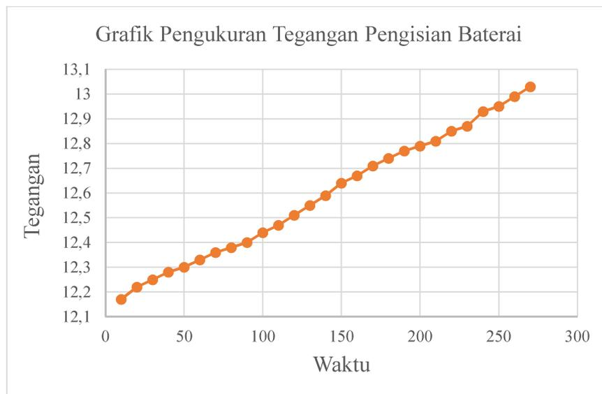
Gambar 5.16 Grafik pengukuran tegangan pengisian baterai
