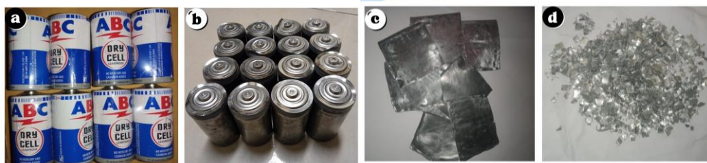
Gambar IV.1 (a) Baterai Primer D 1,5 V; (B) Lapisan Kedua Baterai; (C) Lempeng Zn; (D) Potongan Zn Hasil Preparasi
