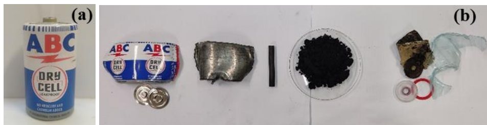
Gambar IV. 1 (a) Baterai Zn-C 1,5 Volt ukuran D (R30) (b) Komponen-komponen penyusun baterai
