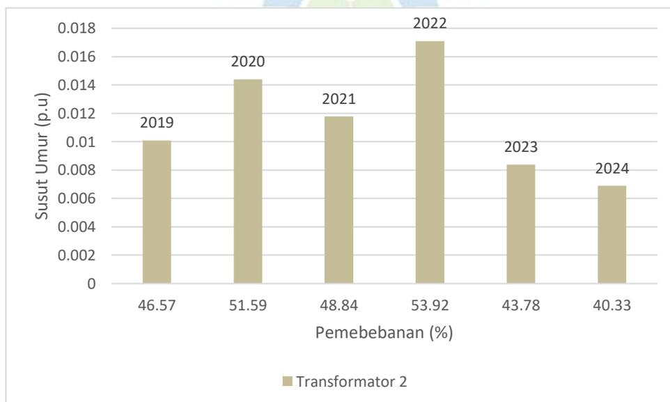
Gambar 5. 9 Grafik pengaruh pembebanan terhadap susut umur transformator 2
