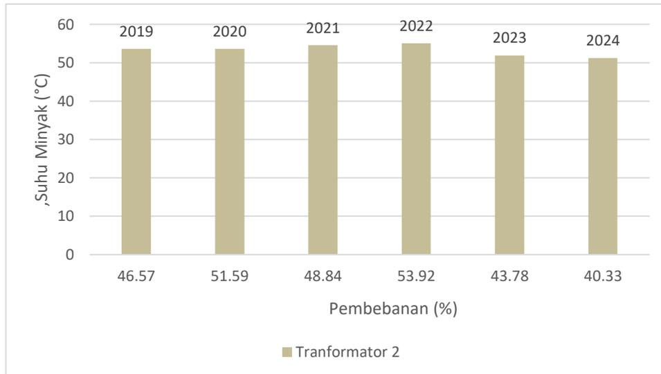
Gambar 5. 7 Grafik pengaruh pembebanan terhadap suhu minyak tranformator 2
