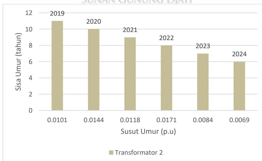
Gambar 5. 11 Grafik pengaruh susut umur terhadap sisa umur transformator 2
